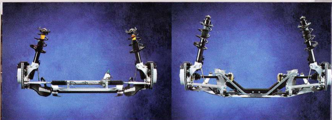
Essieu McPherson avec bras de suspension et jambe de force sur le Boxster
